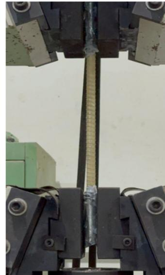
Fig. 4. GFRP bar tensile test.
