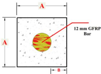
Fig. 2. A= 3.2 cm, 5.2 cm, 6.2 cm, 7.3 cm, 9.2 cm, 11.5 cm, 13.5 cm, 15.5 cm, and 17.5 cm. B= 1 cm, 2 cm, 2.5 cm, 3 cm, 4 cm, 5 cm, 6 cm, 7 cm, and 8 cm. The prism section of the GFRP bar.
