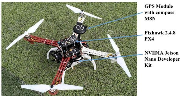
Fig. 1. Quadrotor UAV.
