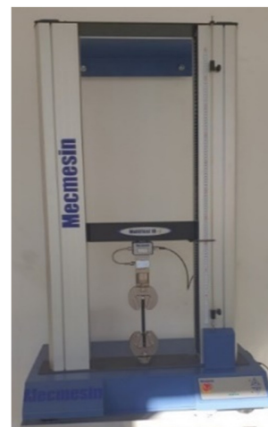
Fig. 4. Tensile test on the Mecmesin Multitest 10-i UTM.
