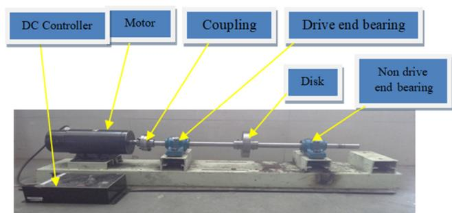
Fig. 1. The rotor test rig.
