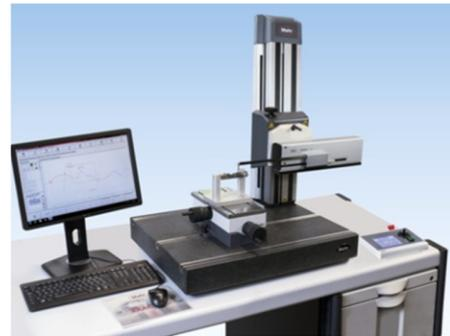
Fig. 2. The 3D-SurfaScan optical profilometer.
