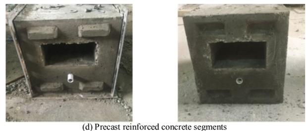
(d) Precast reinforced concrete segments
