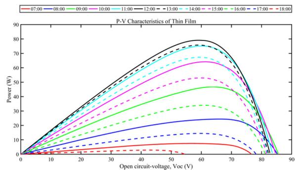
Fig. 11. Power-voltage of the thin film module
