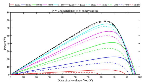
Fig. 7. Power-voltage of the monocrystalline module
