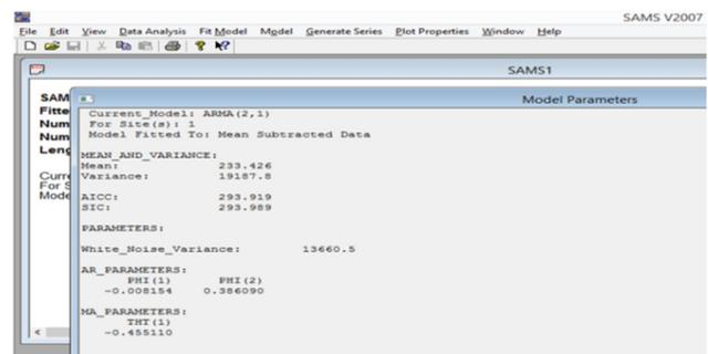
Fig. 1. SAMS parameter estimation for an ARMA(2,1) model.
